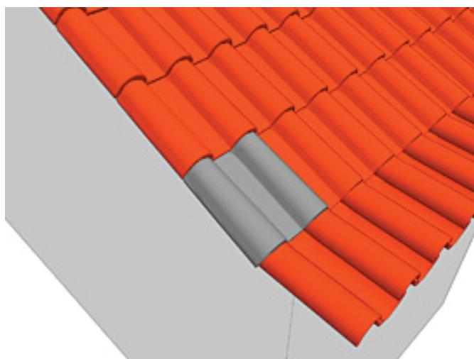
Seguindo os procedimentos propostos para o assentamento das telhas (aplicação das telhas da direita para a esquerda e de baixo para cima) conseguem-se os melhores resultados no acabamento estético do telhado. Na figura seguinte pode observar-se como a aplicação da telha dupla permite o adequado remate da empena.
