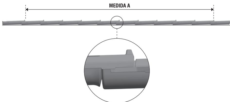
Recolher 12 telhas e encaixá-las em posição invertida sobre uma superfície plana de modo a ficarem o mais aproximadas possível entre si. Com as telhas nesta posição, mede-se a distância em centímetros entre a 2ª e a 12ª telha - MEDIDA A.
