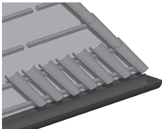
Por sua vez as ripas devem ser interrompidas 2 a 3 centímetros em pontos alternados a cada 3 ou 4 metros para permitir a circulação de ar, tal como está exemplificado na figura seguinte.
