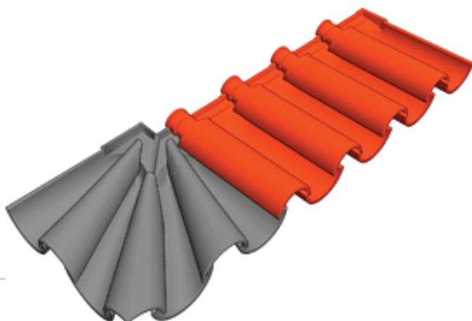
É junto dos cantos e com os cantos que se fazem os ajustes dimensionais do beirado. No entanto, pode chegar a ser necessário “jogar” com a telha ao longo de toda a linha de beirado, de forma a obter peças certas, quando chegar à 1ª peça do canto.
