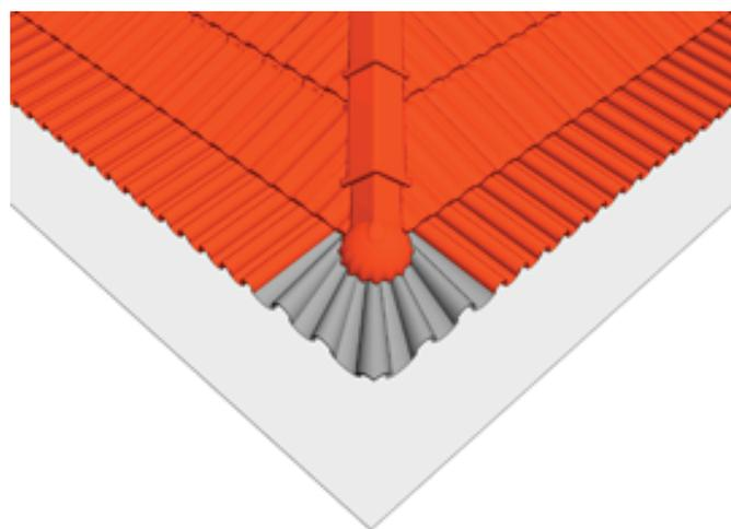
É junto dos cantos e com os cantos que se fazem os ajustes dimensionais do beirado. No entanto, pode chegar a ser necessário “jogar” com a telha ao longo de toda a linha de beirado, de forma a obter peças certas, quando chegar à 1ª peça do canto.
