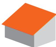
**IMAGEM A** cobertura de uma água ou telheiro – cobertura inclinada constituída por uma vertente.
